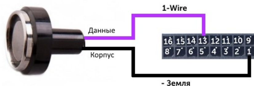
Рис. 4.3. Схема подключения считывателя авторизованных ключей к шине 1-Wire.
